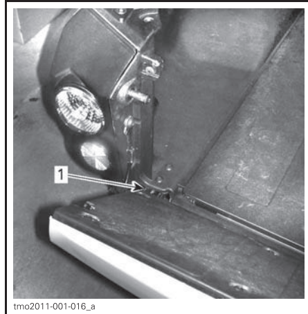
1. Петля заднего борта верхней секции багажного отделения
