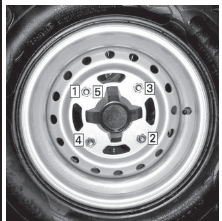
ПОСЛЕДОВАТЕЛЬНОСТЬ ЗАТЯЖКИ
