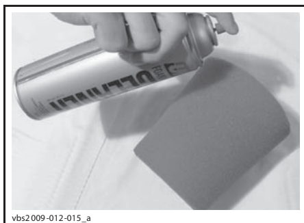
ТИПОВОЙ ВАРИАНТ — НАНЕСИТЕ НА ВНУТРЕННЮЮ И НАРУЖНУЮ ПОВЕРХНОСТИ ПРЕДВАРИТЕЛЬНОГО ФИЛЬТРУЮЩЕГО ЭЛЕМЕНТА
