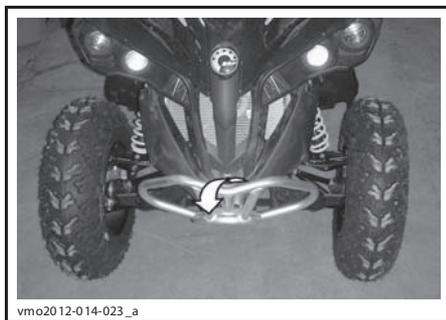
ТИПОВОЙ ВАРИАНТ — МЕСТО КРЕПЛЕНИЯ ПЕРЕДНЕЙ ЧАСТИ МОТОВЕЗДЕХОДА
