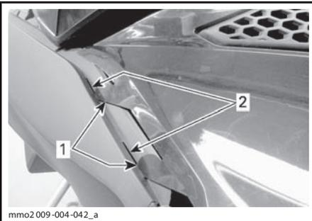
1. Нижние фиксаторы панели
