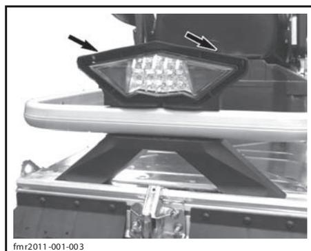
**ВНИМАНИЕ** Если задний фонарь неосторожно переместить в сторону, пластиковые фиксаторы могут сломаться. При снятии заднего фонаря избегайте боковых перемещений.
