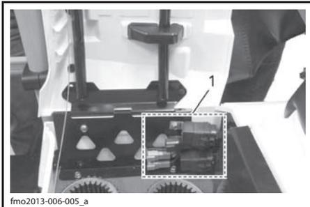
1. Электрические разъёмы для подключения дополнительного оборудования
