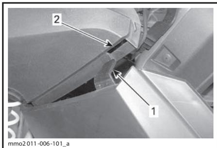
1. Нижний фиксатор боковой панели
