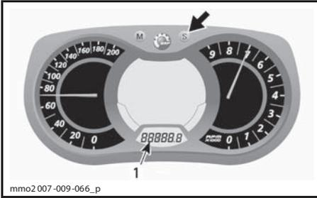
1. Режим счётчика пробега за поездку (TRIP B)
