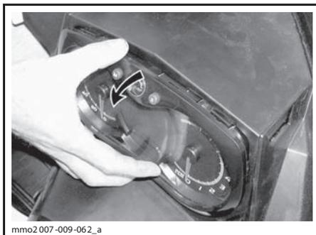
3. Отсоедините разъём перегоревшей лампы. Снимите резиновый чехол.
