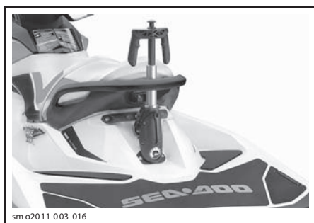
ТИПОВОЙ ВАРИАНТ — ПИЛОН ФАЛА ВОДНО-ЛЫЖНИКА/ВЕЙКБОРДИСТА ПОДНЯТ
