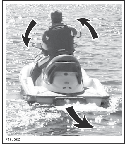
ТИПОВОЙ ВАРИАНТ — ИСПОЛЬЗУЙТЕ ПРОТИВОПОЛОЖНОЕ НАПРАВЛЕНИЕ ПОВОРОТА РУЛЯ ПРИ ДВИЖЕНИИ ЗАДНИМ ХОДОМ
