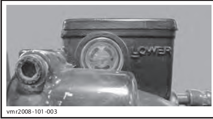
ЛЕВАЯ СТОРОНА — КОМПЕНСАЦИОННЫЙ БАЧОК ГИДРОПРИВОДА ЗАДНИХ ТОРМОЗОВ
