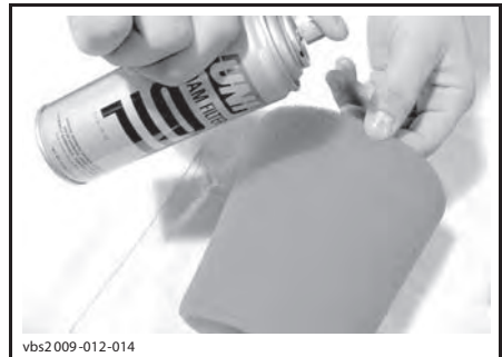
ТИПОВОЙ ВАРИАНТ — НАНЕСЕНИЕ МАСЛА НА ФИЛЬТРУЮЩИЙ ЭЛЕМЕНТ
