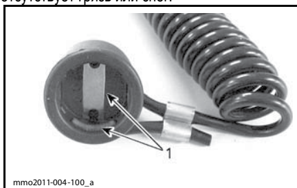
КОЛПАЧОК ШНУРА БЕЗОПАСНОСТИ 1. Отсутствует снег или грязь
