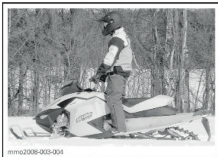
**Положение водителя на снегоходе при движении задним ходом**
