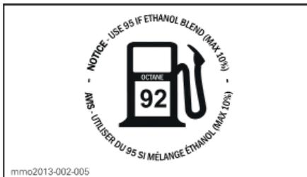
РАСПОЛОЖЕНА НА КРЫШКЕ ТОПЛИВНОГО БАКА – НА ДВИГАТЕЛЯХ АСЕ – В СТРАНАХ, ИСПОЛЬЗУЮЩИХ ОБОЗНАЧЕНИЕ ОКТАНОВОГО ЧИСЛА ПО ИССЛЕДОВАТЕЛЬСКОМУ МЕТОДУ – ВНИМАНИЕ: В СЛУЧАЕ НАЛИЧИЯ В ТОПЛИВЕ ЭТАНОЛА (10% МАКСИМУМ) ИСПОЛЬЗУЙТЕ ТОПЛИВО С ОКТАНОВЫМ ЧИСЛОМ НЕ НИЖЕ 95 RON
