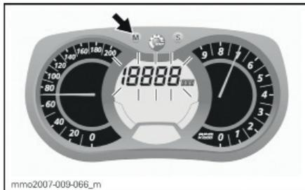
Пока выбранный дисплей мигает нажмите кнопку SET (S) для отображения значения общего расхода топлива.
