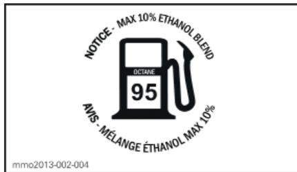
РАСПОЛОЖЕНА НА КРЫШКЕ ТОПЛИВНОГО БАКА – НА ДВИГАТЕЛЯХ E-TEC – В СТРАНАХ, ИСПОЛЬЗУЮЩИХ ОБОЗНАЧЕНИЕ ОКТАНОВОГО ЧИСЛА ПО ИССЛЕДОВАТЕЛЬСКОМУ МЕТОДУ – ВНИМАНИЕ: МАКСИМАЛЬНОЕ СОДЕРЖАНИЕ ЭТАНОЛА В ТОПЛИВЕ 10%
