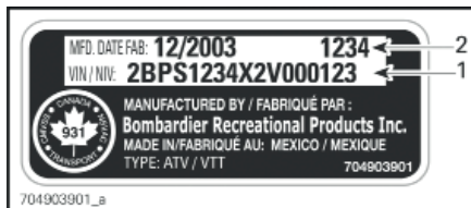
ТАБЛИЧКА 2 1. Идентификационный номер транспортного средства (VIN) 2. Номер модели
