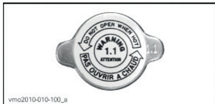
НАКЛЕЙКА 9 – РАСПОЛОЖЕНА НА КРЫШКЕ РАДИАТОРА – ПРЕДОСТЕРЕЖЕНИЕ – НЕ ОТКРЫВАТЬ ПОКА ГОРЯЧИЙ
