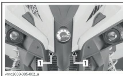
ТИПОВОЙ ВАРИАНТ 1. Поднимите здесь
