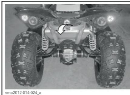
ТИПОВОЙ ВАРИАНТ – РАСПОЛОЖЕНИЕ ЗАДНЕЙ ТОЧКИ КРЕПЛЕНИЯ
