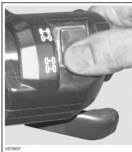
ТИПОВОЙ ВАРИАНТ – РЕЖИМ 4WD
