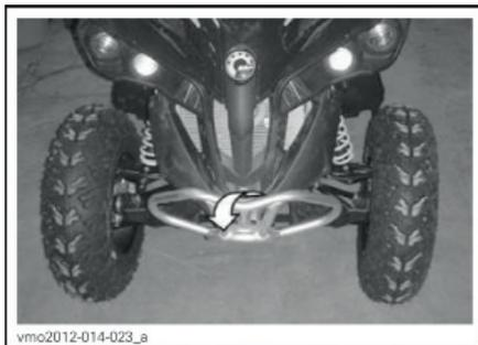
ТИПОВОЙ ВАРИАНТ – РАСПОЛОЖЕНИЕ ПЕРЕДНЕЙ ТОЧКИ КРЕПЛЕНИЯ
