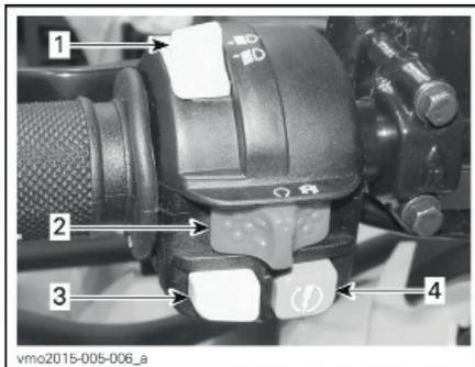
МНОГОФУНКЦИОНАЛЬНЫЙ ПЕРЕКЛЮЧАТЕЛЬ -ТИПОВОЙ ВАРИАНТ
