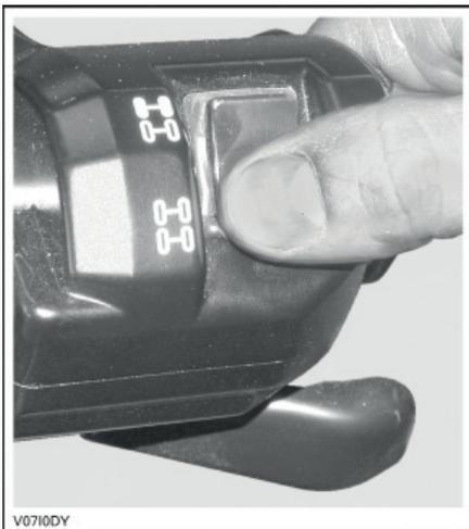
*РЕЖИМ ПОЛНОГО ПРИВОДА (4WD) – ТИПОВОЙ ВАРИАНТ*
