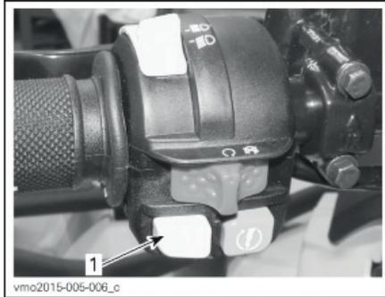
1. Кнопка блокировки автоматике / выбора режима работы усилителя руля (DPS)
