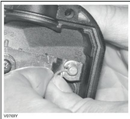
Снимите боковую крышку корпуса дроссельной заслонки.
