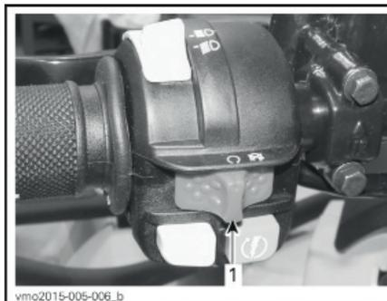
1. Аварийный выключатель двигателя
