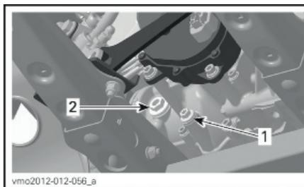
1. Магнитная пробка сливного отверстия
