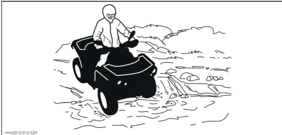
Мокрые тормоза негативно повлияют на возможности тормозной системы. После движения по воде, грязи или снегу обязательно несколько раз приводите в действия тормоза, для того чтобы просушить их. Оставляйте больше места для торможения.
