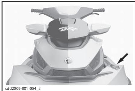
ТИПОВОЙ ВАРИАНТ — РАСПОЛОЖЕНИЕ КРЫШКИ ТОПЛИВОЗАПРАВОЧНОЙ ГОРЛОВИНЫ
