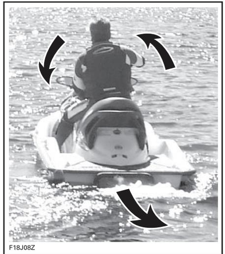
**ТИПОВОЙ ВАРИАНТ — ИСПОЛЬЗУЙТЕ ПРОТИВОПОЛОЖНОЕ НАПРАВЛЕНИЕ ПОВОРОТА РУЛЯ ПРИ ДВИЖЕНИИ ЗАДНИМ ХОДОМ**
