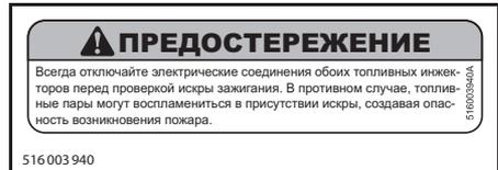
ТАБЛИЧКА 11 — ТОЛЬКО МОДЕЛИ С ДВИГАТЕЛЕМ E-TEC
