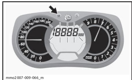
При мигающем дисплее нажмите кнопку SET (S) для выбора режима тахометра.
