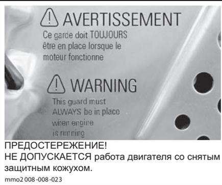
ТАБЛИЧКА 16 — НА КОЖУХЕ ТОРМОЗНОГО ДИСКА (МЕТАЛЛИЧЕСКИЙ ТОННЭЛЬ)
