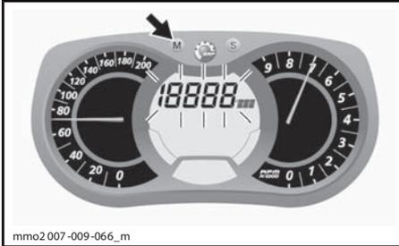
При мигающем дисплее нажмите кнопку SET (S) для выбора режима суммарного расхода топлива (ТС).
