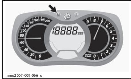
Для сброса показаний установите счётчик пробега за поездку в режим TRIP B, как подробно описано в параграфе «СЧЁТЧИК ПРОБЕГА ЗА ПОЕЗДКУ «А» ИЛИ «В».
