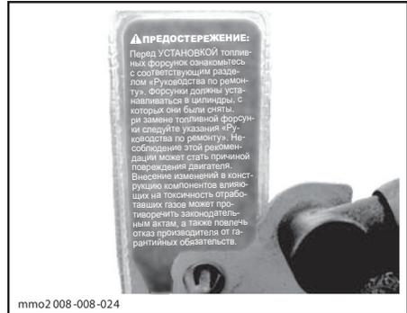
ТАБЛИЧКА 18 — НА ТОПЛИВНЫХ ФОРСУНКАХ — МОДЕЛИ E-TEC
