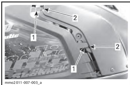
1. Передние фиксаторы панели
