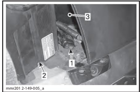
1. Предохранитель системы зарядки (20 А)
