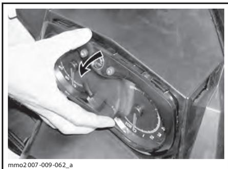
3. Отсоедините разъем перегоревшей лампы. Снимите резиновый чехол.
