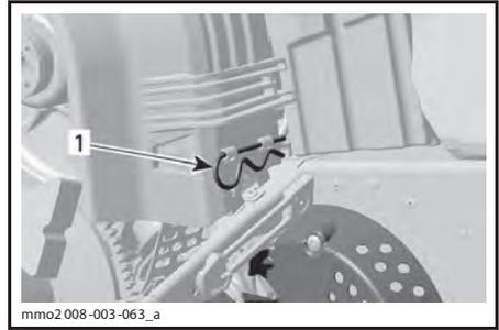
1. Проволоочный фиксатор
