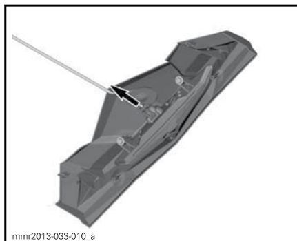
Снимите опору заднего фонаря с посадочного места и отсоедините электрический разъем.
