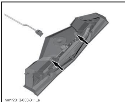
Снимите оба винта крепления заднего фонаря
