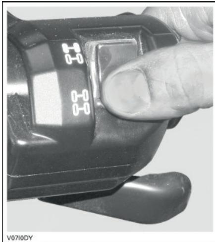
РЕЖИМ ПОЛНОГО ПРИВОДА (4WD) – ТИПОВОЙ ВАРИАНТ
