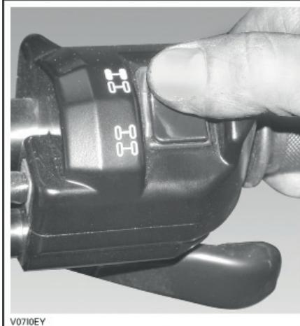
РЕЖИМ ПРИВОДА НА ДВА КОЛЕСА (2WD) – ТИПОВОЙ ВАРИАНТ
