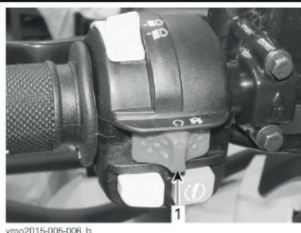
1. Аварийный выключатель двигателя
