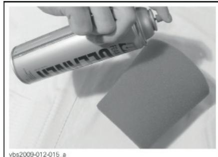
ТИПОВОЙ ВАРИАНТ – НАНЕСИТЕ ОЧИСТИТЕЛЬ НА ПОРОЛОНОВЫЙ ФИЛЬТР
