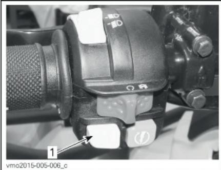
1. Кнопка блокировки автоматики / выбора режима работы усилителя руля (DPS)
