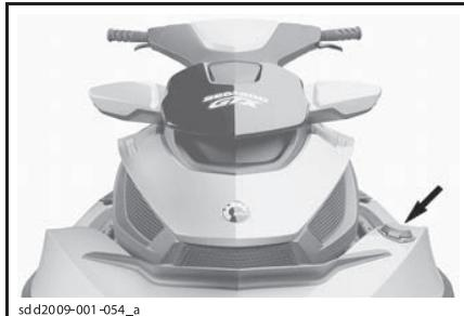
ТИПОВОЙ ВАРИАНТ – РАСПОЛОЖЕНИЕ КРЫШКИ ТОПЛИВНОГО БАКА
