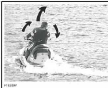
Поворот руля приводит к повороту сопла водомета, что задает направление движения. Поворот руля вправо приведет к повороту гидроцикла вправо, и наоборот. Во время выполнения поворота следует нажимать рычаг дроссельной заслонки.
