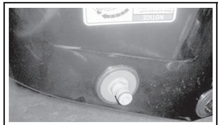
ТИПОВОЙ ВАРИАНТ – БЫСТРОСЪЕМНЫЙ ПЕРЕХОДНИК
