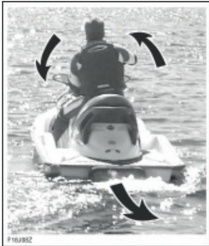
ТИПОВОЙ ВАРИАНТ – РУЛЕНИЕ ПРИ ДВИЖЕНИИ ЗАДНИМ ХОДОМ
