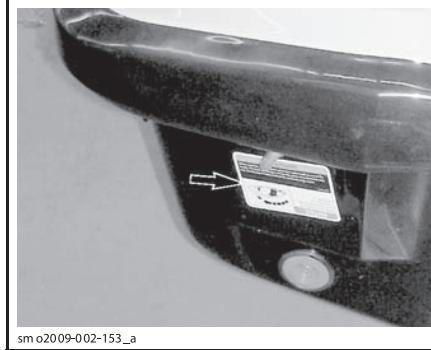
Двигатель 4-ТЕС™ имеет систему защиты (T.O.P.S.™). При опрокидывании гидроцикла двигатель автоматически выключается.
