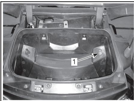
1. Разъём для подключения внешних аудиоустройств
